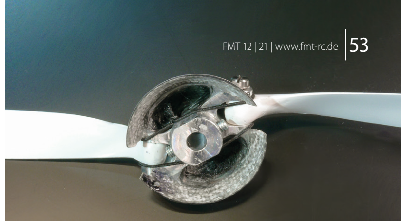
Der kleine Magnet am Spinnerrand (links unten) signalisiert der Hallsonde, wo sich die Ruhelage der Luftschraubenblätter befindet.
